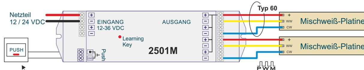
Anschluss eines bauseitigen Tasters möglich
