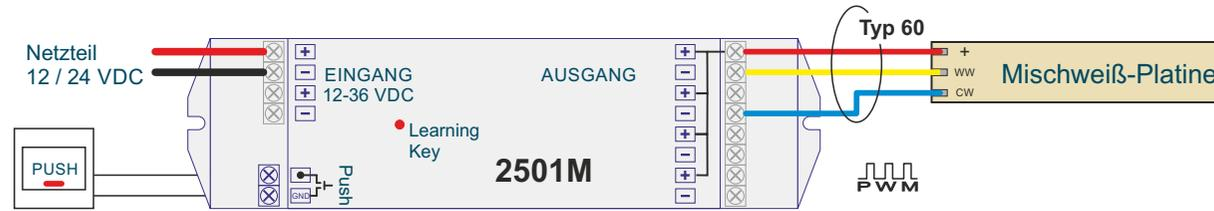
Anschluss eines bauseitigen Tasters möglich
