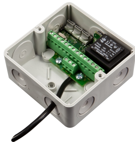
Das DMX-Interface mit geöffnetem Gehäusedeckel
