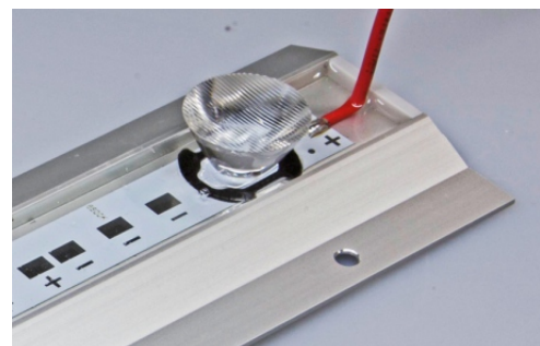
LED, Optik und Platine hermetisch dicht vergossen
