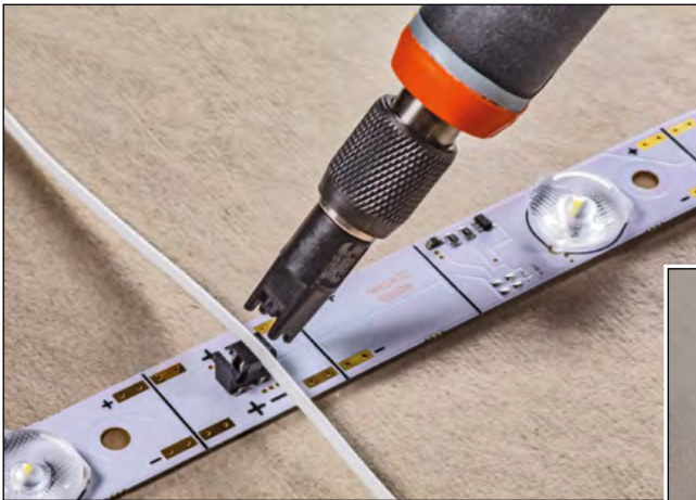
Ebenfalls zum Zubehör gehört ein Spezialwerkzeug – Griff und extra Werkzeugeinsatz, mit dem die Leitungen in die Schneidklemme gedrückt wird.
